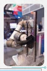
機械臂模擬抹窗動作 The robotic arm simulating window cleaning action 此系統的研發目的在於減少人 力使用,並在自主和半自主兩 種模式下運行一自主模式需要 BIM技術提供建築物外牆的數 據,機器人可根據數據在沒有 工人的情況下,自主規劃路 號,機器人可根據數據在沒有 工人的情況下,自主規劃路 續 規檢查 清潔工作,令工人不用 以選擇遠程操作機器人系統, 有利於非常規的外牆清潔工 作,大大降低了人力成本,減 少事故發生幾率,從而降低風 險和保險成本。 機械臂 Robotic Arm
